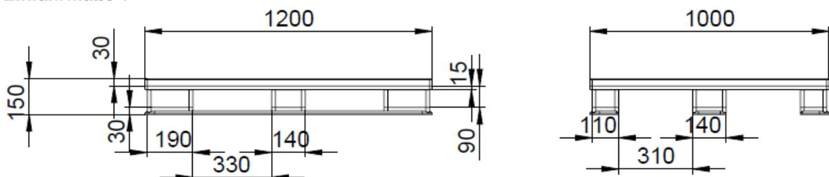
\*Alle Traglastangaben gelten nur bei gleichmäßiger Flächenlast | Für alle Maßangaben gelten Toleranzen von +/- 3 mm
